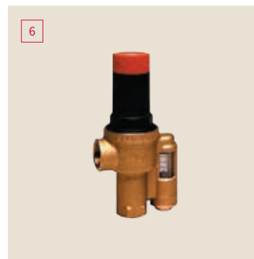
Różnicowy zawór upustowy Wyposażenie utrzymuje stały przepływ do skraplacza pompy ciepła. ATW-DPOV-01
